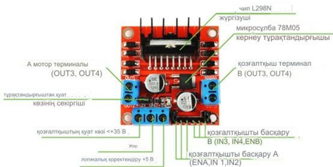
3.12-сурет – L298N драйвері құрылымы
